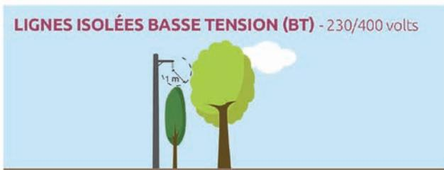
*Enedis demande que l'élagage soit réalisé en augmentant d'au moins un mètre les distances prévues à la construction des lignes.*
